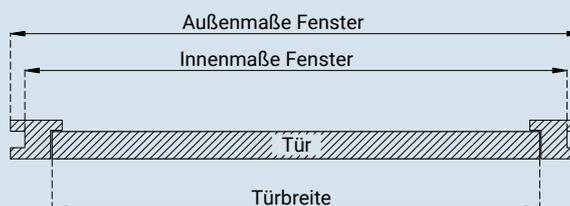
Diese Fenster sind für Blockhausprofile von 28 bis 70mm oder in Kombination mit einem Grundrahmen geeignet.
