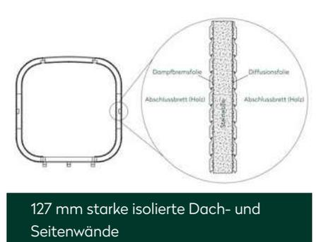
127 mm starke isolierte Dach- und Seitenwände
